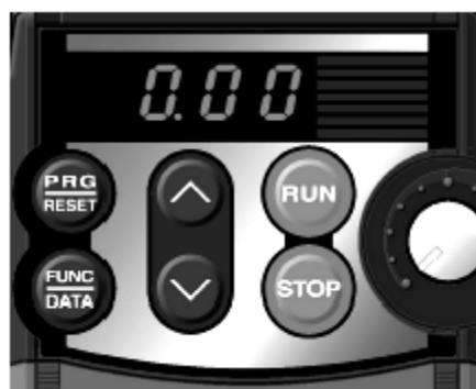
Рис.4.2. Показание СД дисплея после включения питания.
