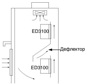
Рис. 3-2 Установка нескольких преобразователей
