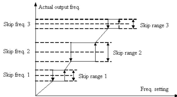
Рис. 6-10 Работа преобразователя при пропуске частот
