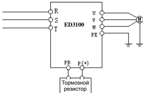
Рис. 2-1 Подключение тормозного блока к преобразователю
