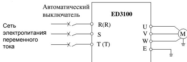
Рис.3-3 Простое подключение силовых цепей
