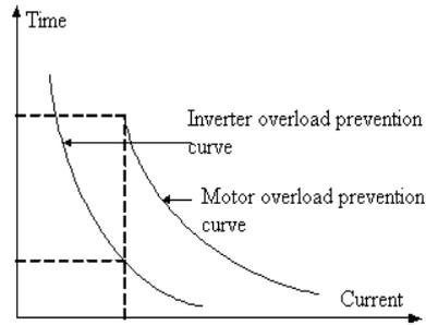
Рис. 6-30 Кривые срабатывания токовой защиты преобразователя и электродвигателя
