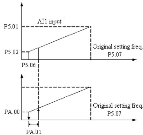
Рис. 6-33 Гистерезис на нулевой частоте
