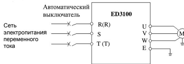
Рис.3-3 Простое подключение силовых цепей
