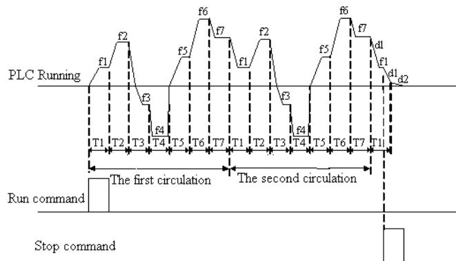
Рис. 6-27 Непрерывный цикл
