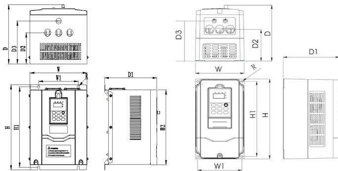
Размеры преобразователей: а): мощностью 0,75кВт~4,0кВт
