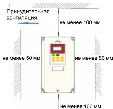
Рис. 3-1 Пространство, требующееся для установки преобразователя
