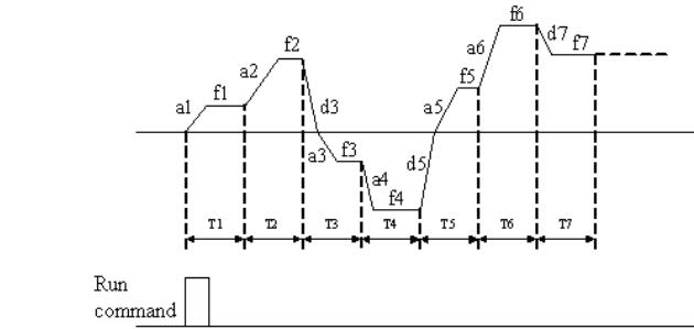
Рис. 6-28 Удерживание конечного значения после одиночного цикла
