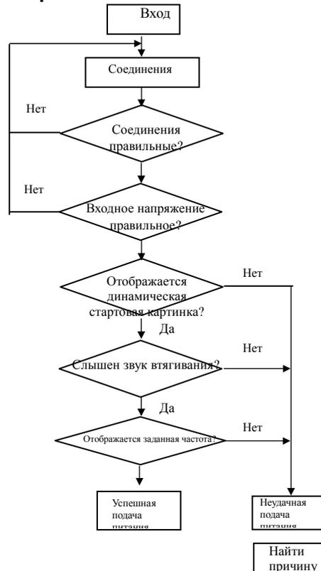
режим запуска, а на дисплее отображается заданная частота, свидетельствуя о завершении подачи электропитания. Процесс первоначальной подачи электропитания представлен на Рисунке 4-11.
