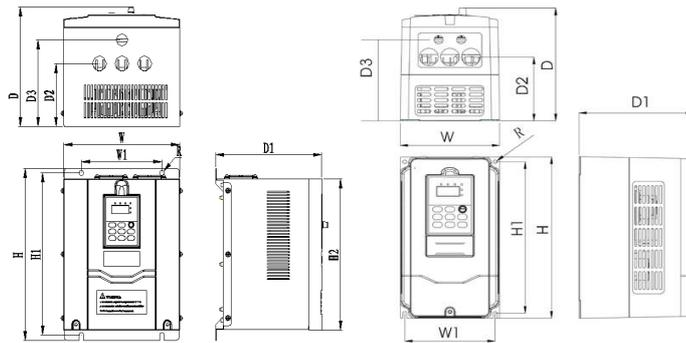
Размеры преобразователей: а): мощностью 0,75кВт~4,0Вт
