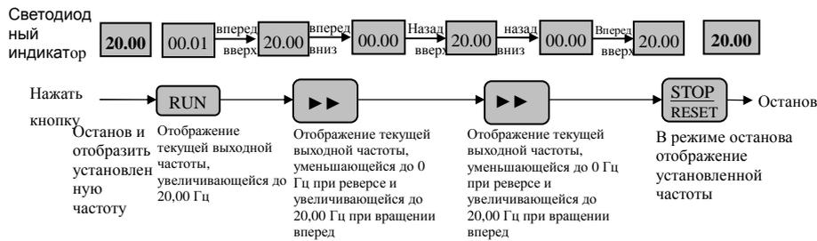
Рис.4-10 Пример переключения между пуском, остановом вращением вперед
