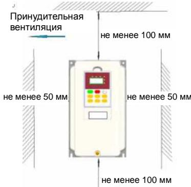
Рис. 3-1 Пространство, требующееся для установки преобразователя
