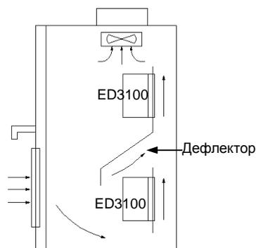
Рис. 3-2 Установка нескольких преобразователей
