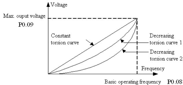
Рис. 6-4 Вольт-частотная кривая
