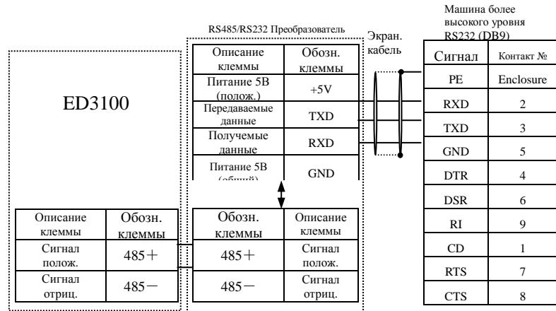
Рис.3-11 Схема электрических соединений при подключении к портам RS485- (RS485/232) -RS232
