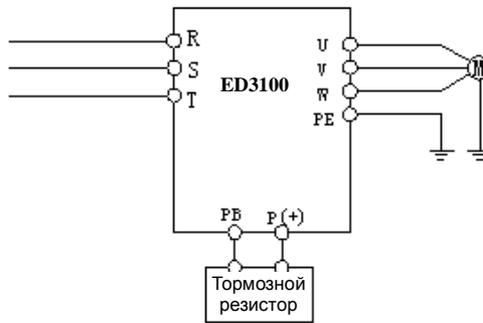
Рис. 2-1 Подключение тормозного блока к преобразователю
