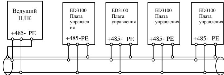
Рис. 3-12 Схема соединений, обеспечивающих связь программируемого логического контроллера и нескольких преобразователей (все преобразователи и электродвигатели должны быть надежно заземлены)
