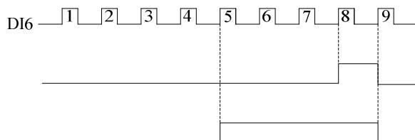
Рис.6-18 Значение сброса счетчика и контрольное значение счетчика
