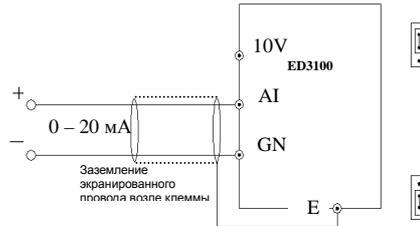
Рис. 3-9 Подключение к клемме AI2
