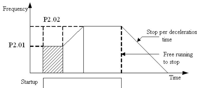
Рис. 6-6 Выходные кривые пуска и останова
