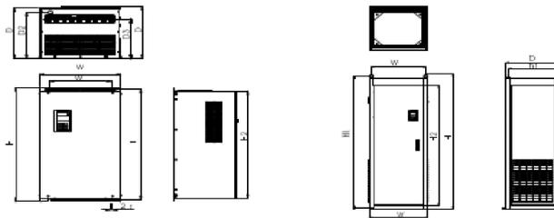
д): мощностью 37 кВт ~ 110 кВт е): мощностью 132 кВт ~ 315 кВт
