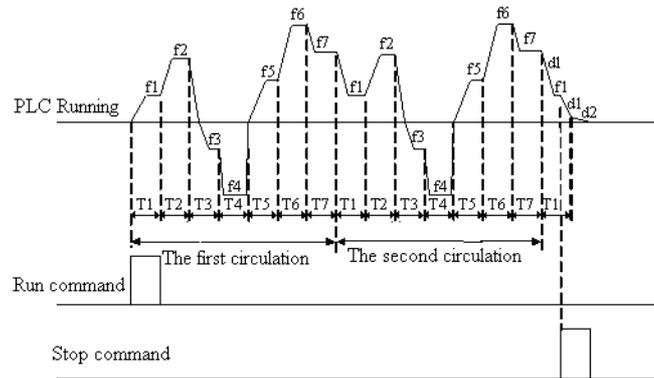
Рис. 6-27 Непрерывный цикл
