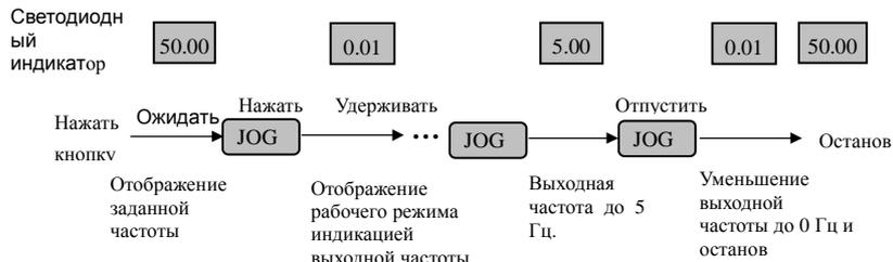
Рис.4-9 Пример управления в толчковом режиме
