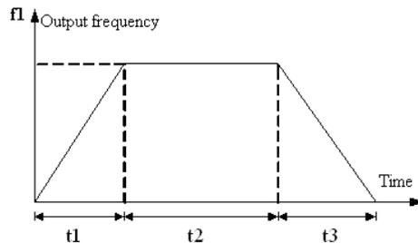
Рис. 6-9 Параметры при толчковом режиме работы
