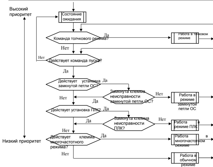
Рис. 4-1 Логическая диаграмма рабочих состояний преобразователя серии ED3100
