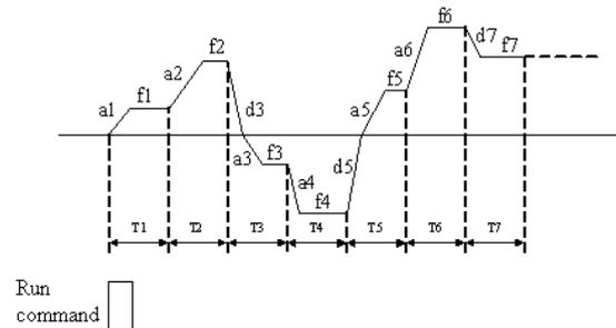
Рис. 6-28 Удержание конечного значения после одиночного цикла
