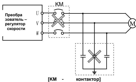
Рис. 1-3 На выходе преобразователя не допускается установка конденсатора
