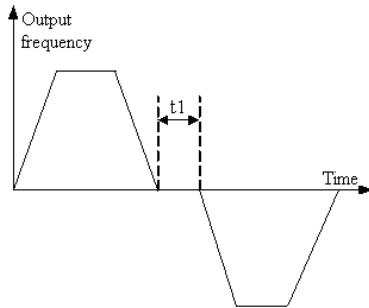
Рис. 6-8 Интервал мертвого зоны при изменении направления вращения
