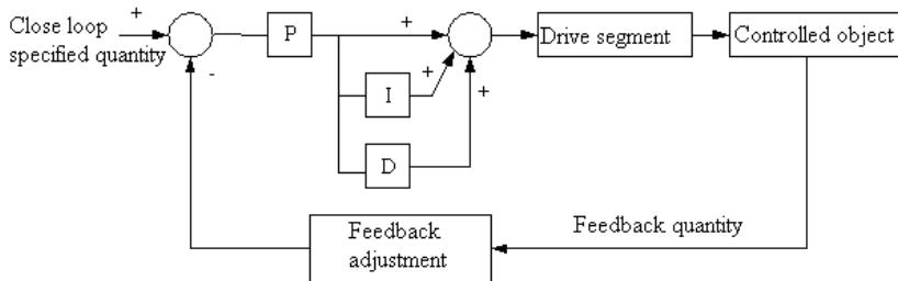
Рис. 6-21 Работа ПИД-регулятора
