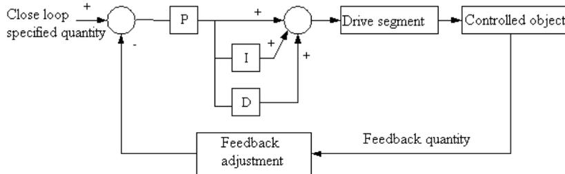
Рис. 6-21 Работа ПИД-регулятора
