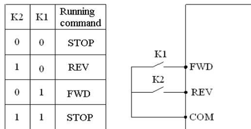
Рис.6-11 Режим управления двухпроводной линией 1
