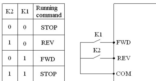
Рис.6-11 Режим управления двухпроводной линией 1
