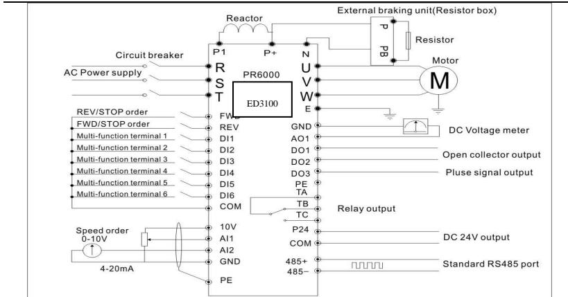
Рис. 3-6 Типовая схема электрических соединений для преобразователей ED3100-4T0220M ~ ED3100-4T3150M
