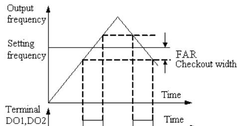
Рис.6-17 Выходной сигнал, соответствующий допустимому створу частоты FAR
