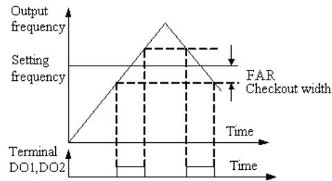
Рис.6-17 Выходной сигнал, соответствующий допустимому створу частоты FAR
