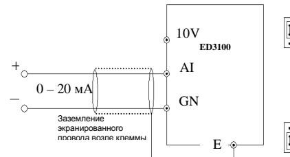
Рис. 3-9 Подключение к клемме AI2
