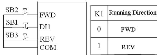
Рис.6-14 Режим управления трехпроводной линией 2
