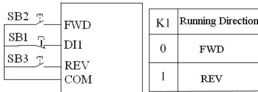
Рис.6-14 Режим управления трехпроводной линией 2
