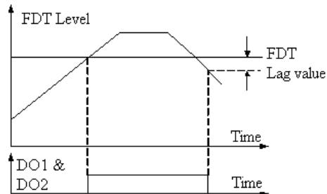
Рис.6-16 Установка уровня и задержки FDT (определения частоты)
