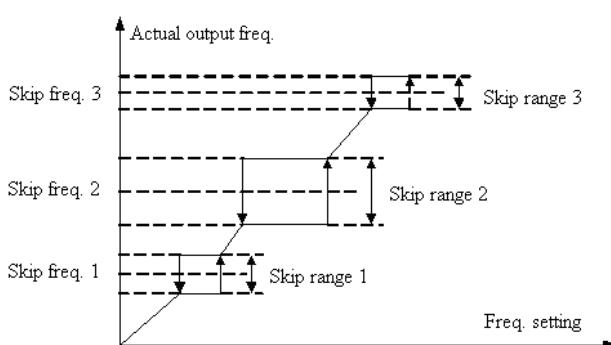
Рис. 6-10 Работа преобразователя при пропуске частот
