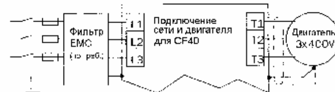
Рис. 1 Монтаж фильтра EMC
