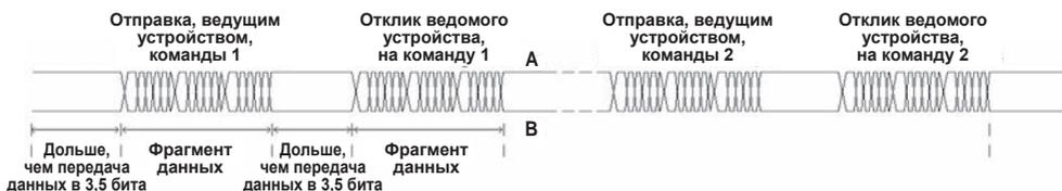
Встроенный коммуникационный протокол преобразователя частоты серии FIT является протоколом ведомого устройства Modbus-RTU, которое может получить пакет «запрос / команда» от ведущего устройства, и выполнить определенные действия, ответив на него.
