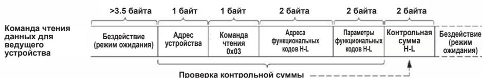
Теоретически, устройство верхнего класса, может считывать непрерывно несколько функциональных кодов, в одно и тоже время (может достигать максимум - 12), но обратите внимание на то, что оно не может считать величину, после последнего значения в последнем функциональном коде, в противном случае, при отклике возникнет ошибка.
