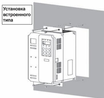
Рис.3-1-3в Встроенная установка в пластиковом корпусе
