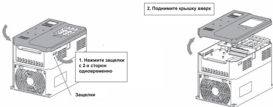
Рис. 3-1-5а Демонтаж верхней крышки прибора в пластиковом корпусе
