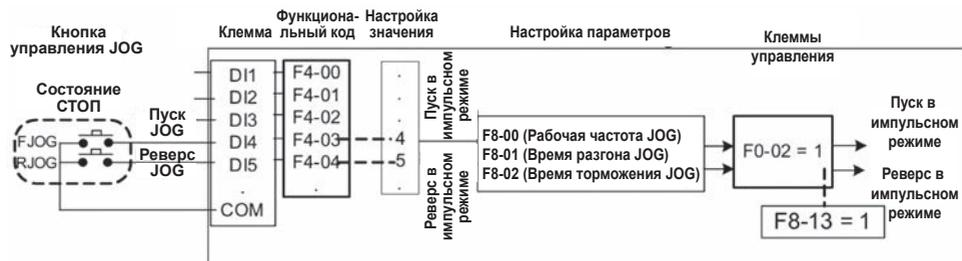
Рис. 4-7-5-2 Режим "JOG" с помощью клеммы DI
