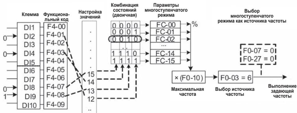
Рис. 4-8-7 Режим настройки многоступенчатого режима
