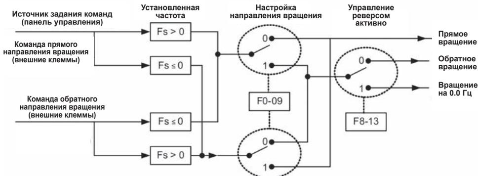
Рис. 4-8-8 Настройка направления вращения двигателя
