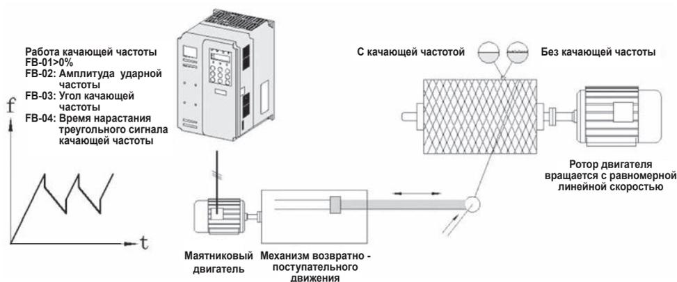
Рис. 4-8-6 Режим качающей частоты
