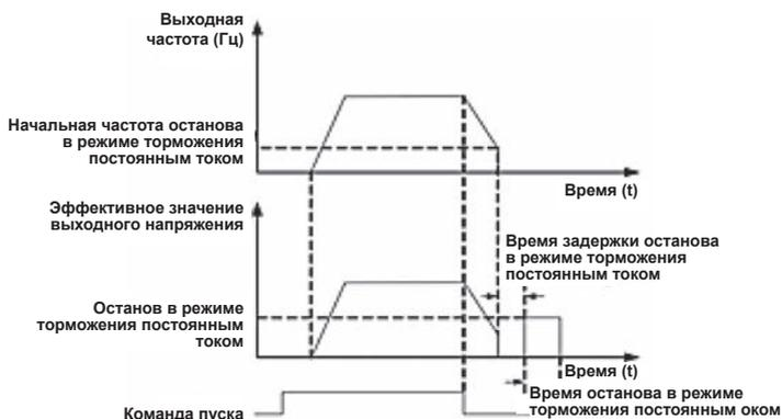
Рис. 6-6в Останов с функцией торможения постоянным током
