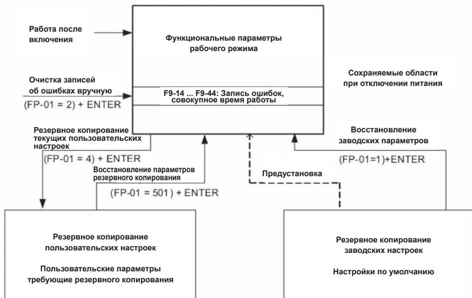
Рис. 4-18 Параметры резервного копирования и восстановление к заводским настройкам
