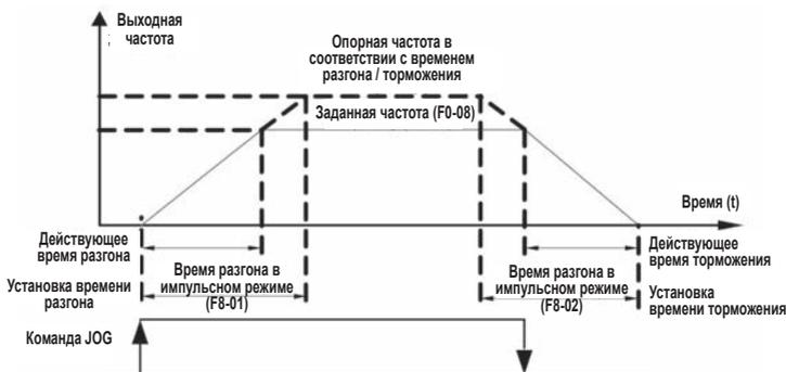
Fig. 4-7-5 Импульсный режим
