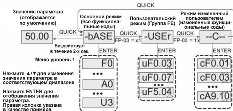
Рис. 4.4 Переключение режимов отображения функциональных кодов
