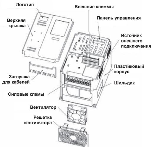
Рис. 2-2-а Пластмассовый корпус преобразователя частоты.
