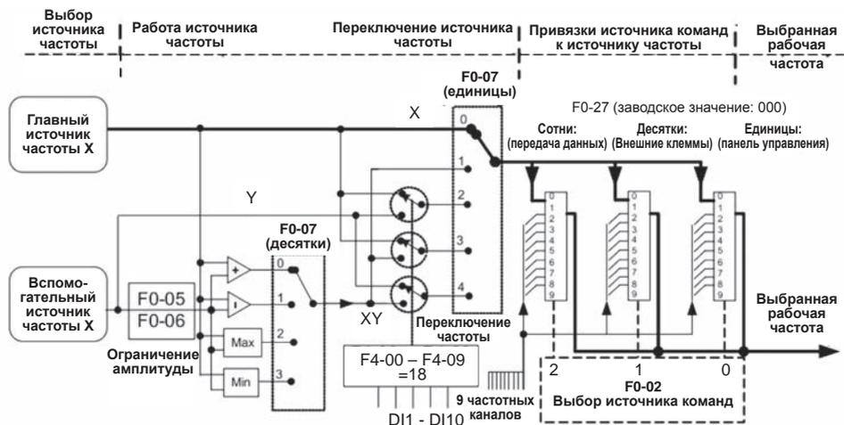
Fig. 4-8-26 Выбор комбинированного источника частоты
