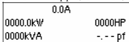
Если плата измерения напряжения не установлена в устройстве плавного пуска то, то индикация мощности будет вычислена на основании напряжения, указанного в параметре «8N».
