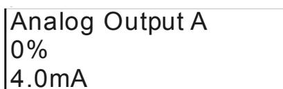
Подключите к аналоговому выходу измерительный прибор. Используя клавиши ▼ и ▲, настройте уровень сигнала в процентах по показаниям дисплея. Значения токового сигнала на приборе должно быть таким же, как и на дисплее пульта. Если имеется плата дополнительных выходов, то можно проверить также работу выходных реле D, E, F и аналогового выхода В.
