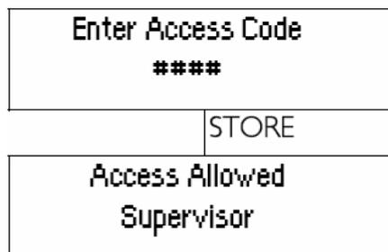
Средства симулятора и сброс счетчиков работы также защищены кодом доступа. Заводское значение кода доступа - «0000».
